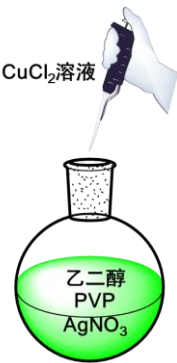
图 2 多元醇法制备银纳米线示意图
