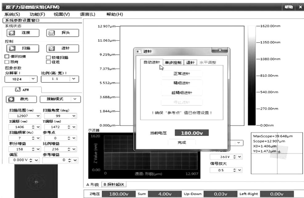
图6 原子力显微镜(AFM)反馈系统
