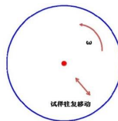
图 4 试样在抛光盘上往复移动
